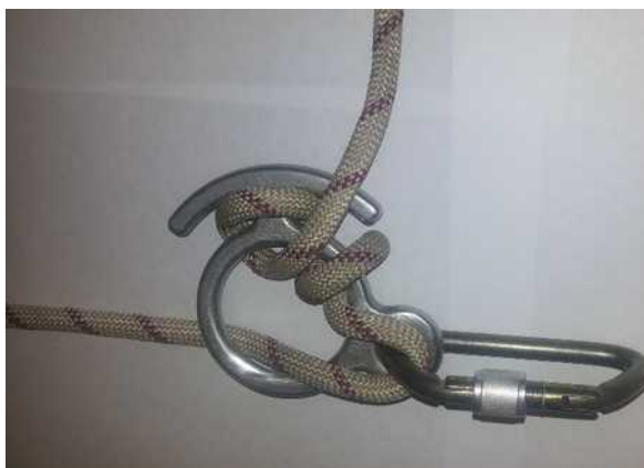
Фото 5.1. Способ блокировки веревки на «восьмерке»
