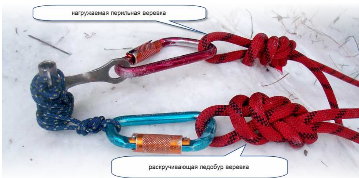
Рисунок 8.3 – Организация спуска со снятием веревок с помощью вывинчивания ледобура
